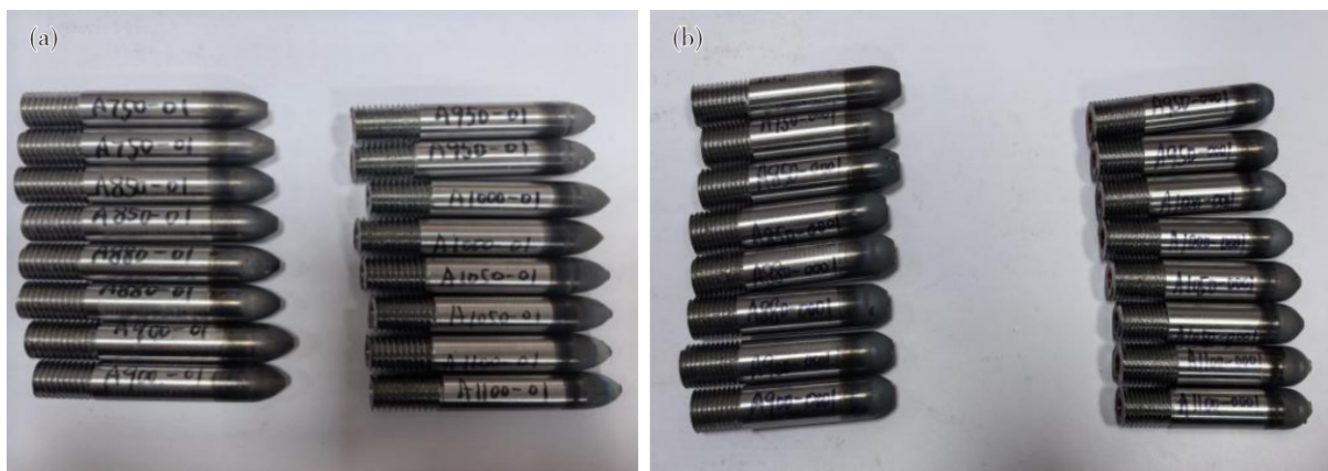
图2 拉断后试样:(a)应变速率 0.1 \text{ s}^{-1} , (b)应变速率 0.001 \text{ s}^{-1}
